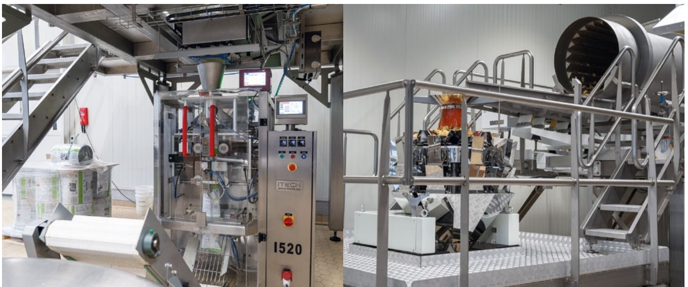
Die Mehrkopfwage hat ein separates Gestell, um die Übertragung der Schwingungen durch das Gewürzsystem zu verhindern. (Bild: Ishida)
